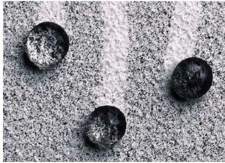
شكل 5 : طلاء Sto Coat LotusanTM ذاتي التنظيف(8)
