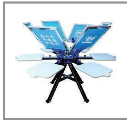
شكل (6) الأداة الدوارة لطباعة لون وأكثر .
