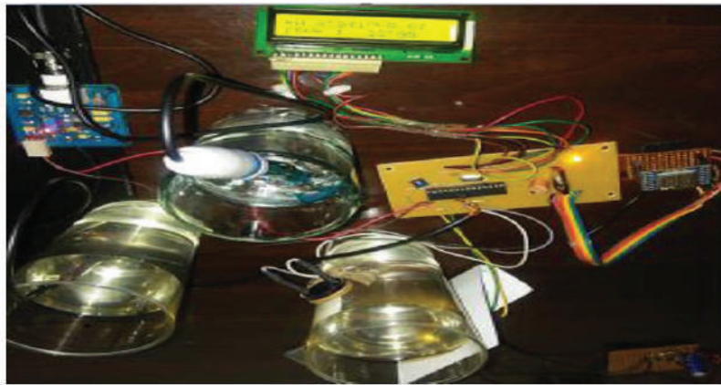
الشكل 16. قيم تحسس جودة المياه معروضة على LCD
