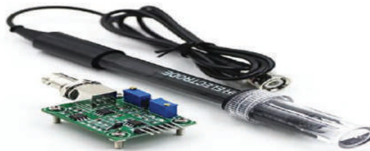
شكل 8. وحدة مستشعر الهيدروجين pH
