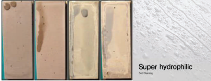
شكل 6 : التنظيف الذاتي لأسطح الخرسانة التي تحتوي على الإسمنت ( TioCem )
