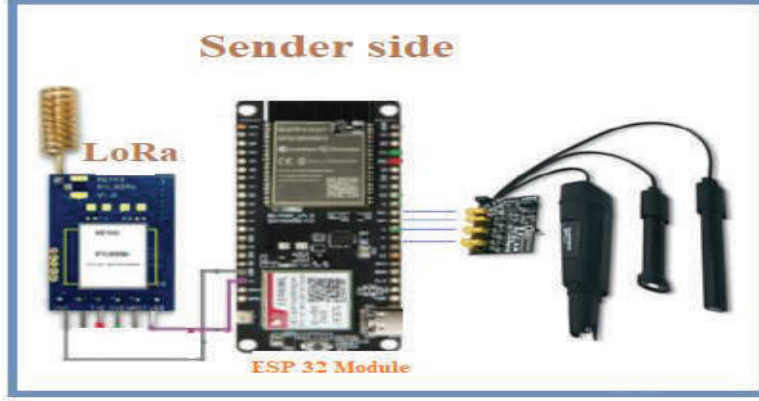
شكل 3. رسم تخطيطي لدائرة نهاية المرسل لنظام الأتمتة الذكية
